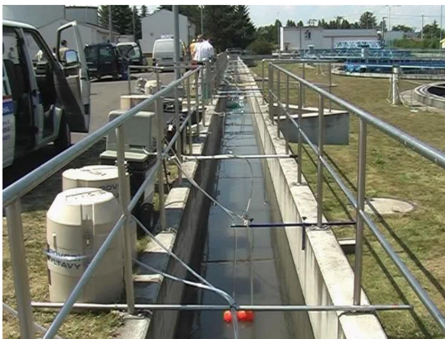
Obr. 2 – odběr automatickými vzorkovači
